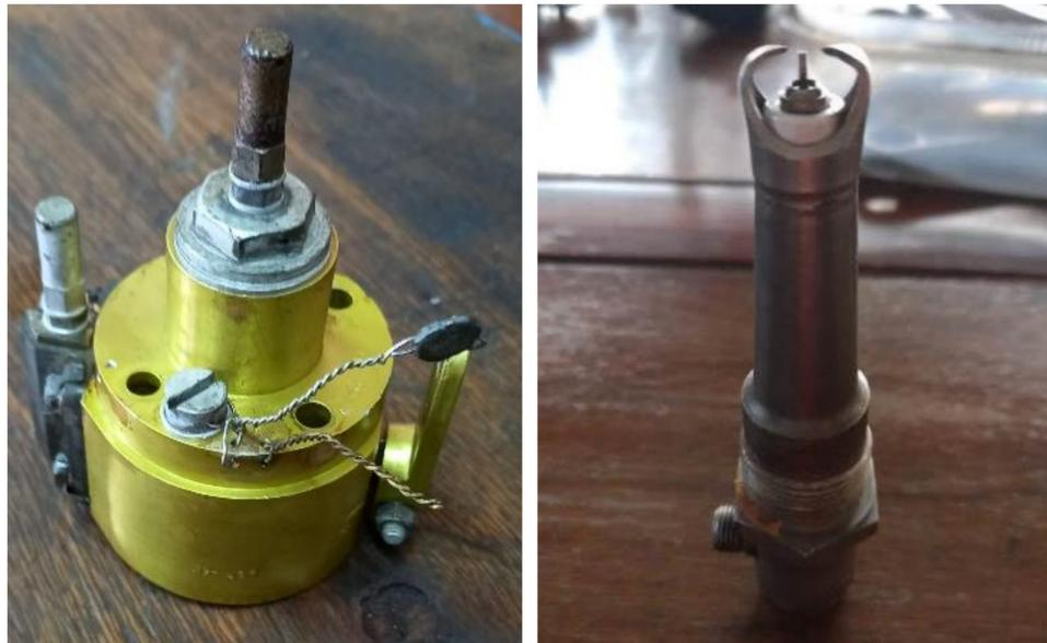
Restauración: Sistema de combustible: Bomba, inyectores, microbomba, líneas, tanques, filtros y sellos.
