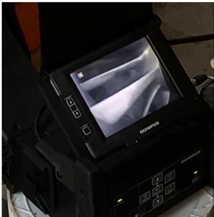
Boroscopia: realizada sobre las ruedas de turbina y cámara de combustión.
